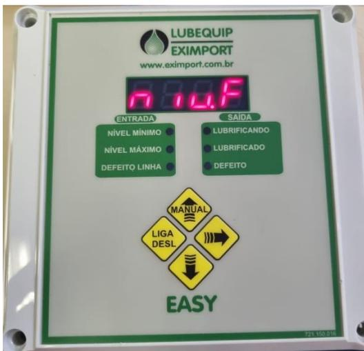
Niu.F (nível mínimo NF do reservatório da bomba). O próximo parâmetro é a chave de nível mínimo. Há 3 opções. NA, NF ou sem a chave de nível. Nesse caso a chave de nível mínimo do reservatório da bomba está em normalmente fechada. Pressionando as “setas para cima ou para baixo” muda essa configuração.
