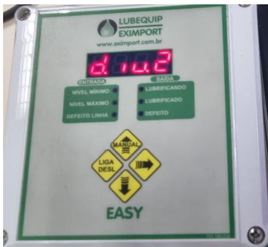
Diu.2 (divisor por 2). Significa que o sistema operará com dois sinais de contato da chave de ciclos para encerrar o ciclo de lubrificação. As “setas para cima ou para baixo” muda essa configuração e a “seta para a direita” vai para a próxima opção. Para sistemas progressivos, de pulverização ou linha simples esta opção não é utilizada.
