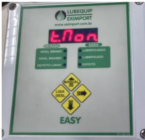
t.Non (tempo de monitoramento). Quando o sistema está funcionando por ciclo, o sistema necessitará de um tempo para monitorar se o distribuidor enviou a quantidade estipulada de lubrificante. Isso se dá pelo tempo de monitoramento. Caso esse tempo de monitoramento acabe, sem que o controlador receba esse sinal, o sistema entrará em falha. O tempo de monitoramento é inserida em minutos.
