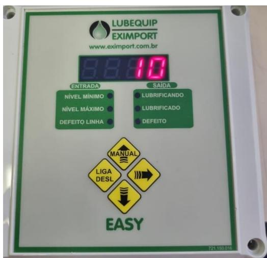
O tempo de pulverização é cotado em segundos. Pode ser deixado zerado ou não, caso o sistema esteja operando como linha simples ou progressivo, esse tempo não afetará seu funcionamento. Contudo para sistemas de pulverização, caso não seja inserido um valor  $>0$ , poderá ocorrer o entupimento dos pulverizadores.
