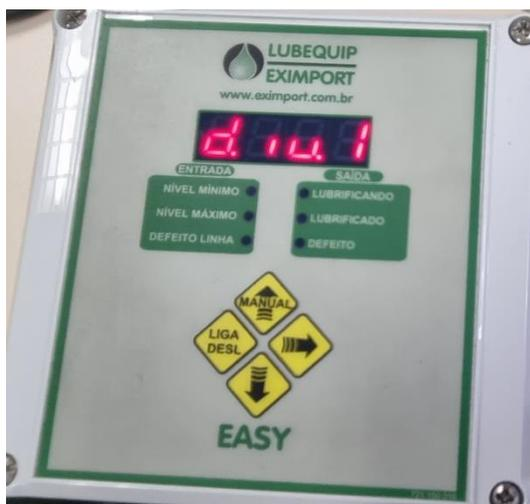
Diu.1 (divisor por 1). Significa que o sistema operará com um contato da chave de ciclos para encerrar o ciclo de lubrificação. As “setas para cima ou para baixo” muda essa configuração e a “seta para a direita” vai para a próxima opção.
