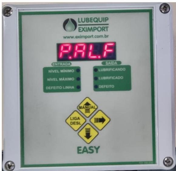
PALF (Pressostato de Alta com contato NF). Indica que no sistema usará um pressostato de alta com fechamento normalmente fechado. Para alettrar utilize as setas “para baixo e para cima”.
