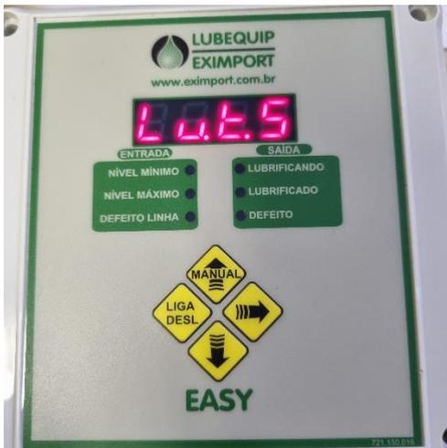
Pressionando, novamente, a tecla “seta para cima ou baixo” o proximo programa é o Lut.S. Que é Lubrificação por Tempo. Nele é necessario programar o tempo de intervalo (P.Int) e o tempo de funcionamento do sistema (P.Lub). A configuração que ficar na tela, será utilizada para programar o controlador. Para ir ao proximo passo, pressione “seta para direita”
