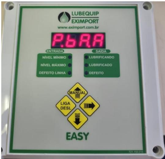
PbAA (Pressostato de Baixa com contato NA).
