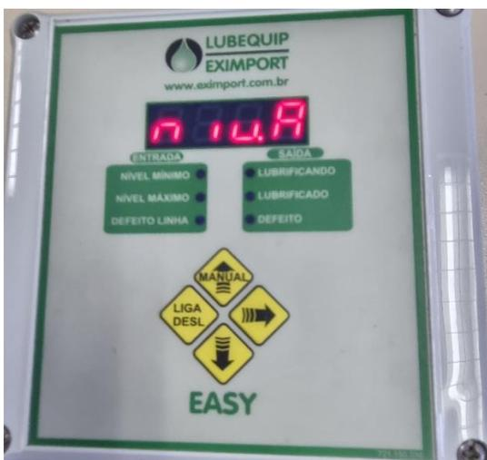
Niu.A (nível mínimo NA do reservatório da bomba). Nesse caso a chave de nível mínimo do reservatório da bomba está em normalmente aberta. Pressionando as “setas para cima ou para baixo” muda essa configuração.
