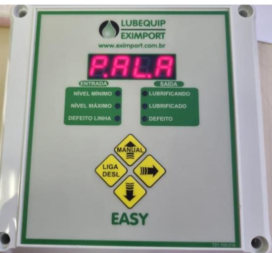
PALA (Pressostato de Alta com contato NA).
