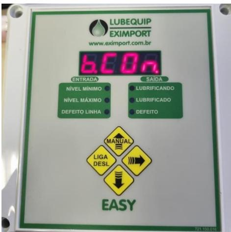
A proxima configuração é em relação a bomba. b.Con (Bomba Contínua) significa que a bomba trabalhará de modo contínuo. Essa configuração é utilizada para sistemas de linha progressiva. Pressionando o botão “seta para cima ou para baixo” muda essa configuração. Para ir ao próximo, pressione “seta para a direita”
