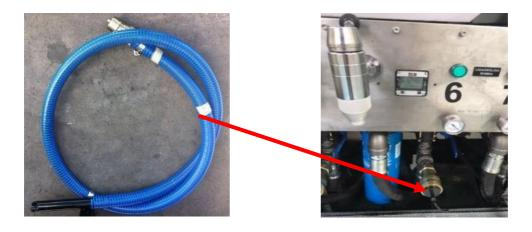
b) Posicione a válvula na posição de Abastecimento como na figura a seguir:
