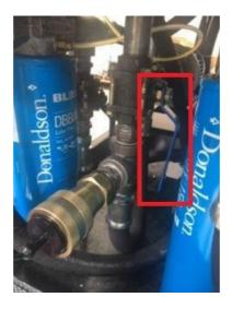
b) Posicione o recipiente em abaixo do dispenser, abra o dispenser e ligue a bomba, após a utilização desligue a bomba, para evitar danos a motobomba e superaquecimento do motor.
