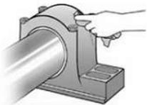
Limpe o local de Instalação do Lubrificador
