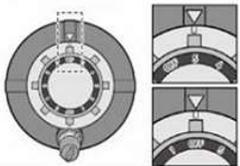
Gire o botão de controle para # 5 para ter certeza Que o lubrificador está dispensando corretamente. Depois da verificação, gire o botão de controle de volta para posição 'OFF'.
