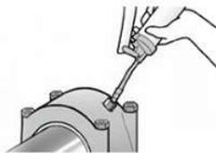
Utilize uma bomba manual para garantir que o ponto de Lubrificação está desobstruído.
