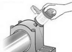
Instale o lubrificador no ponto de lubrificação.
