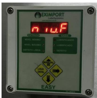
10) APERTAR A SETA PARA DIREITA, IRÁ APARECER T.bLQ. (TEMPO DE BLOQUEIO DO NÍVEL MINÍMO) O TEMPO DE BLOQUEIO DO NÍVEL MINÍMO É O TEMPO PRÉ-AJUSTADO PARA O OPERADOR REABASTECER O SISTEMA, APÓS O MESMO ACENDER O LED DE NÍVEL MINÍMO, CASO O OPERADOR NÃO ABASTEÇA O SISTEMA O MESMO ENTRARÁ EM FALHA, PARA EVITAR DA BOMBA TRABALHAR SEM LUBRIFICANTE.
